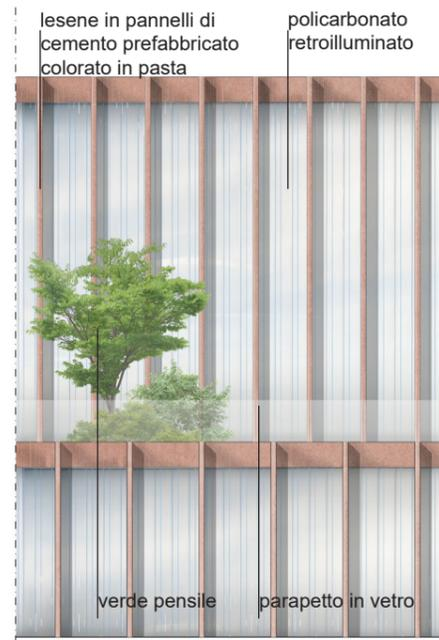
**alleggerito**, con ottime prestazioni sia in termini di trasmittanza che di inerzia termica. Tale soluzione, oltre a **minimizzare i tempi di costruzione**, è studiata al fine di **eliminare tutti i ponti termici** di connessione tra i pannelli, garantendo le massime prestazioni energetiche (STRATIGRAFIA 1).
